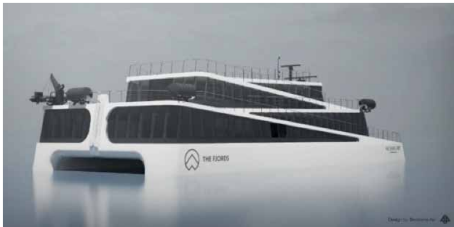
Designet er inspirert, ifølge båtbyggeren, av en typisk norsk fjellsti som ved hjelp av skarpe svinger finner veien oppover fjellsiden – og så tjener dette til at rullestoler kan kjøres fra dekk til dekk. Illustrasjon: Brødrene Aa.
